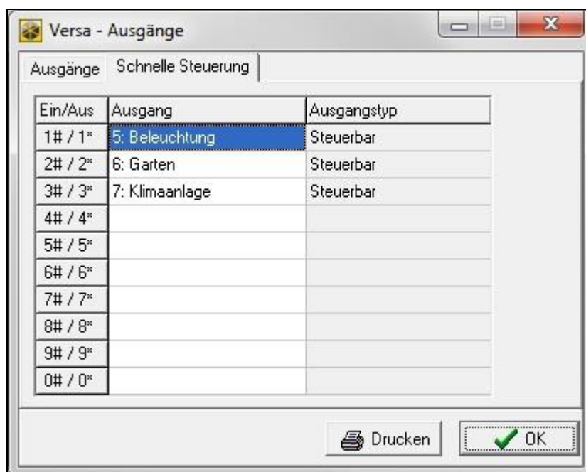
Abb. 11. Programm DLOADX: Zuweisung der Ausgänge den Bedienteiltasten.
