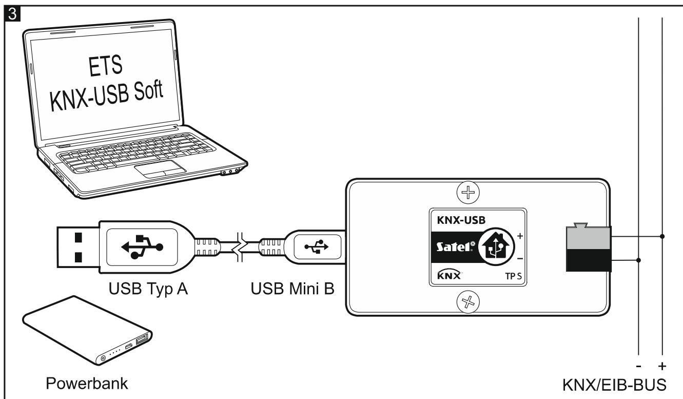
1. Schließen Sie mithilfe der Anschlussklemme die KNX-Busleitung an die Schnittstelle an (Abb. 3).
