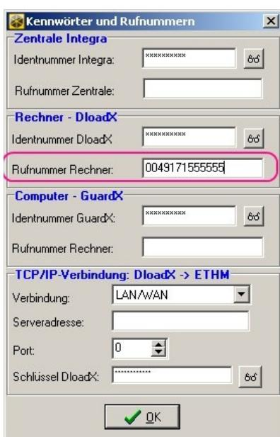
Unter KOMMUNIKATION → KENNWÖRTER und RUFNUMMERN ist unter „Rufnummer Rechner“ die Telefonnummer des Fernwartungsmodems zu hinterlegen. Wählen Sie dazu das internationale Format mit 0049-Ländervorwahl.
